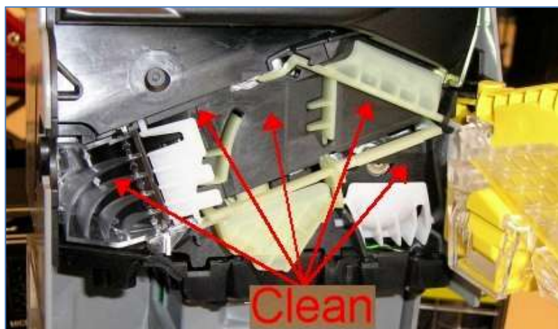
Obrázek 21: Čištění vstupních otvorů
